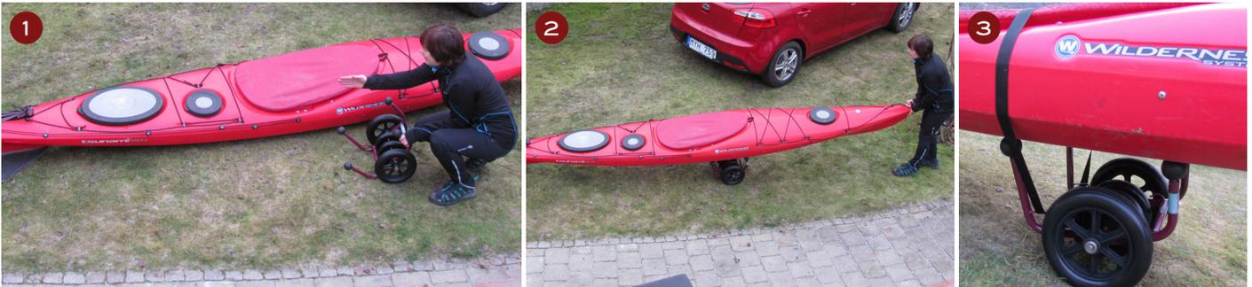
1. Stellen Sie den TROLLER auf die Seite des Kajaks in Richtung des Hecks des Kajaks, die kürzeren Beine des TROLLER, nach oben und vorne.
